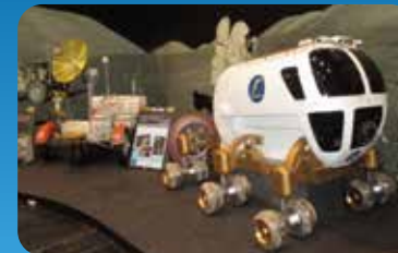
グッドイヤー社が所有する未来型月面車と同社がNASAに提案するスプリングタイヤ
