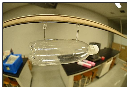
写真4 ペットボトルを使ったロケット
