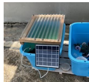
図 4. ソーラー式エアポンプ
